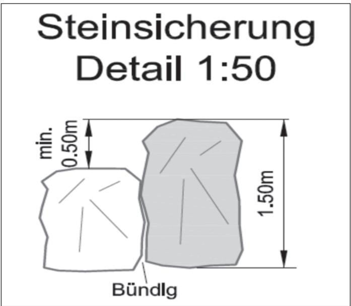
Abb. 5: Detail Steinsicherung, 1:50
