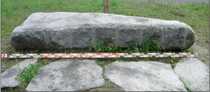
Foto 7: Steine dieser Grössenordnung wurden entlang der Schneckenlinie stehend in die Sohle der Suhre eingebaut.
